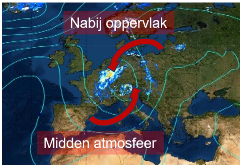
Figuur 2.1: Meteorologische situatie op 14 juli 2021, inclusief een indicatie van de aanvoerroute van vochtige lucht in verschillende luchtlagen. Getoond zijn de 700 hPa drukverdeling (contouren) en een momentopname van de neerslagradar om 12 UTC van de achtereenvolgende dagen. “Nabij oppervlak” is de laag onder 900 hPa, terwijl “Midden atmosfeer” de luchtlag tussen 900 en 700 hPa aangeeft. Resultaten voor alle dagen tussen 11 en 15 juli, en details van de aanvoerbanen van vochtige lucht voor verschillende aanvoerhoogtes staan in Bijlage A.1.
